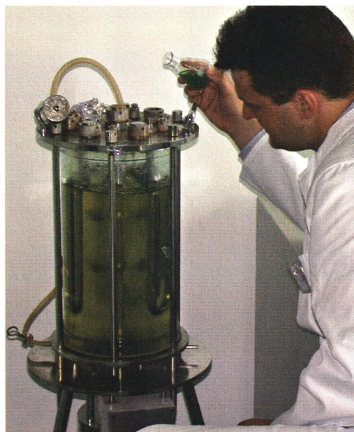
Im Labor erfolgt die Zucht und Ernte von Grünlagen in beleuchteten Glasfermentern.
